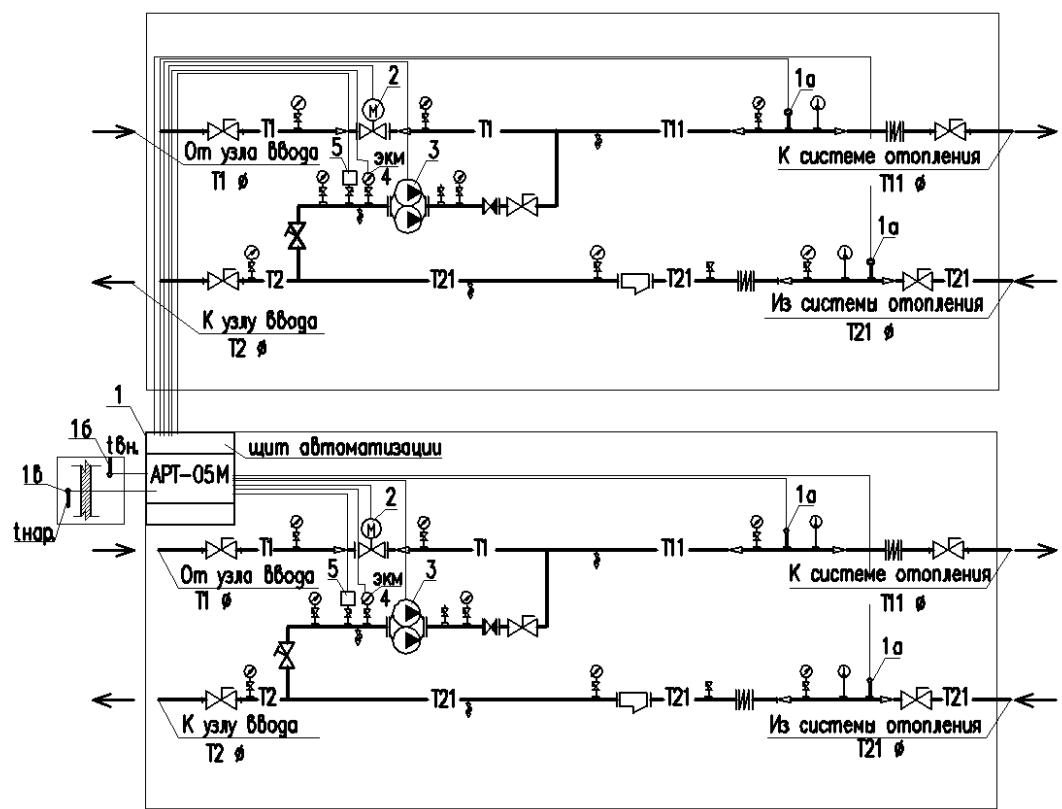
Рекомендуется применять при различных температурных графиках в тепловой сети и в системе отопления ( $T1 > T11$ ).
