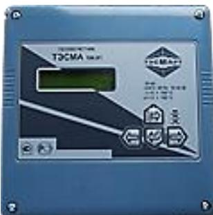
**Предназначен** для измерения и регистрации с целью коммерческого и технологического учета значений потребленного (отпущеного) количества теплоты. В теплосчетчике также реализованы функции измерения, индикации, регистрации технологических параметров систем теплоснабжения и горячего водоснабжения.
