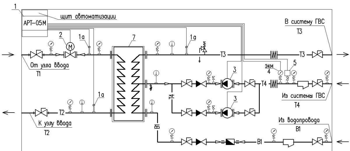
Регулятор поддерживает постоянную температуру горячей воды, ограничивает максимальную температуру теплоносителя, возвращаемого в тепловую сеть после водоподогревателя системы ГВС.
