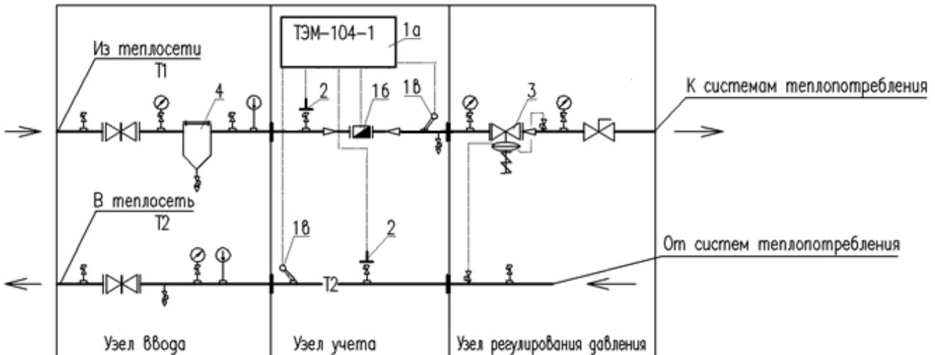
Рис.2 Принципиальная схема блока ввода и учета с двумя ППР
