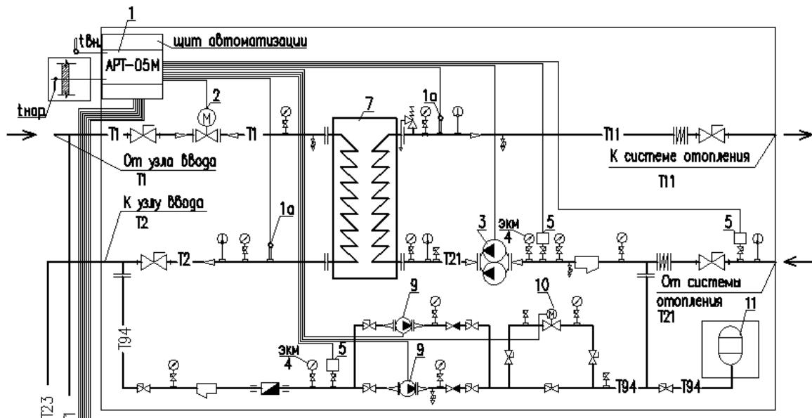
Система ГВС (двухступенчатая смешанная схема)
