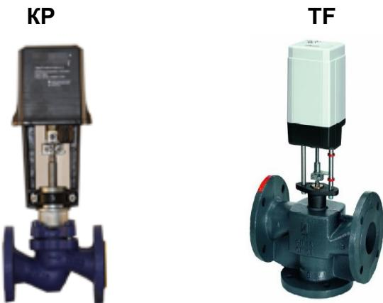
**Предназначены** для автоматического поддержания требуемой температуры в системах отопления, вентиляции и горячего водоснабжения, путем изменения расхода теплоносителя по команде микропроцессорного регулятора РТ-05М (АРТ -05М). Электроприводы клапанов оборудованы муфтой предельного момента, которая защищает электропривод от разрушения при механических перегрузках.
