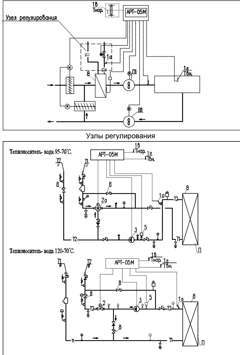
Регулятор осуществляет управление вентиляторами, заслонками с целью поддержания постоянной температуры приточного или внутреннего воздуха, защиту калорифера от замерзания в нем воды по температуре обратного теплоносителя и по температуре воздуха у калорифера.
