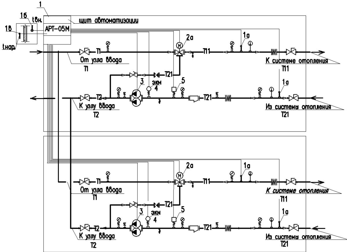
Рекомендуется применять при одинаковых температурных графиках в тепловой сети и в системе отопления ( $T_1 = T_{11}$ ).
