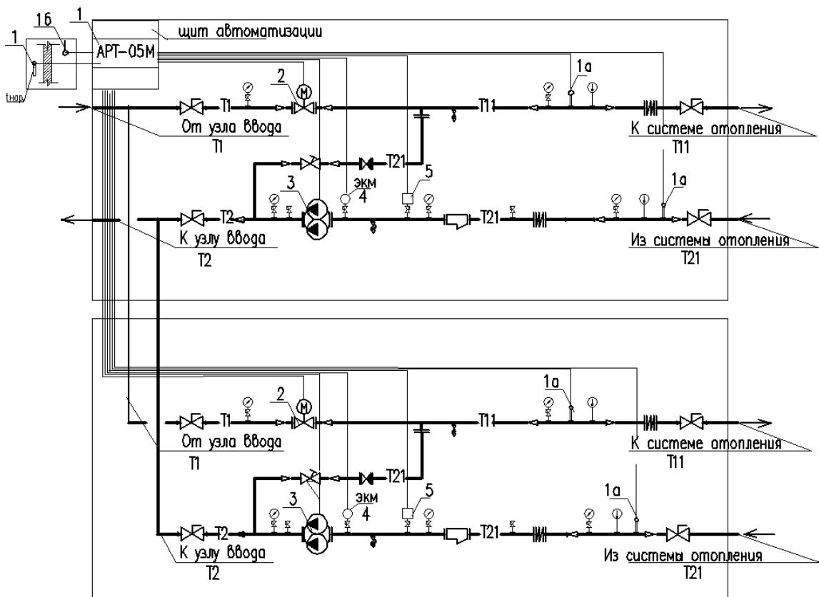
Рекомендуется применять при различных температурных графиках в тепловой сети и в системе отопления ( $T_1 > T_{11}$ ).
