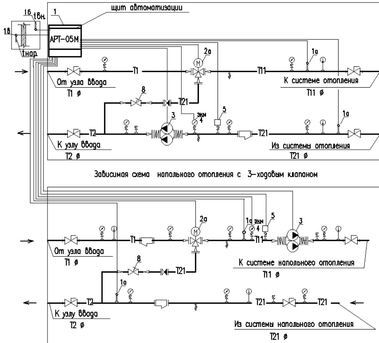
Регулятор поддерживает температуру теплоносителя в системе отопления по температурному графику в зависимости от температуры наружного воздуха.
