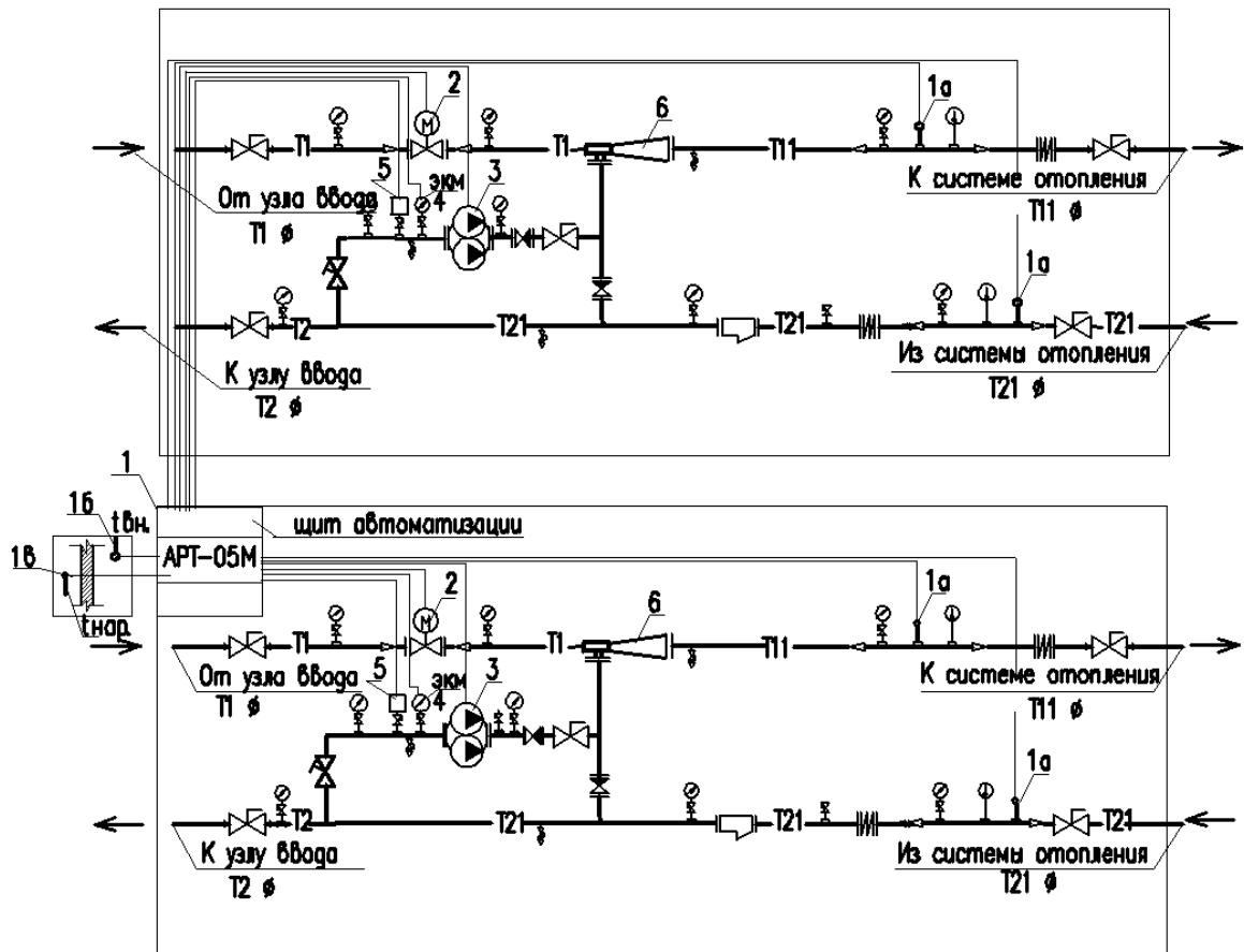
Рекомендуется применять при реконструкции системы отопления, оборудованной элеватором. Применяется, как правило, при различных температурных графиках в тепловой сети и в системе отопления ( $T_1 > T_{11}$ ).
