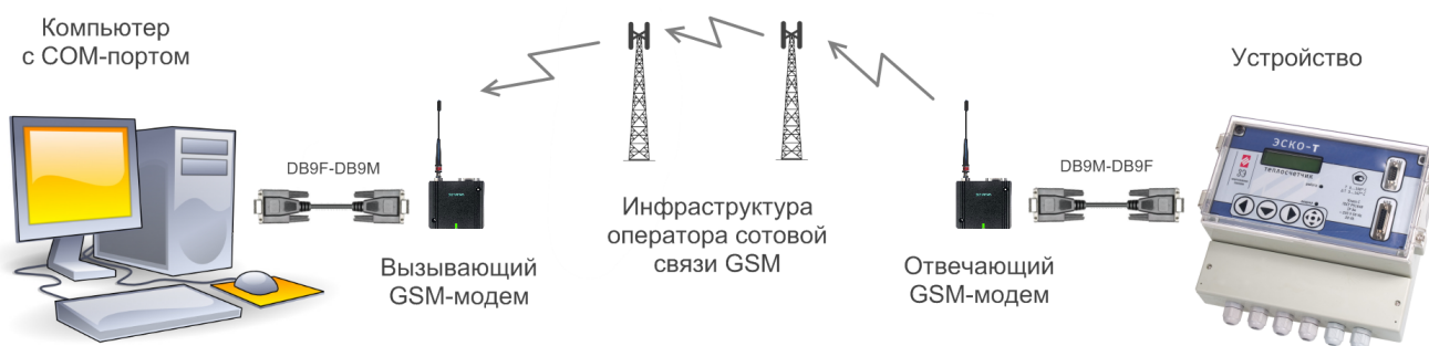
Рисунок 26. Общая схема организации подключения устройств через канал GSM
