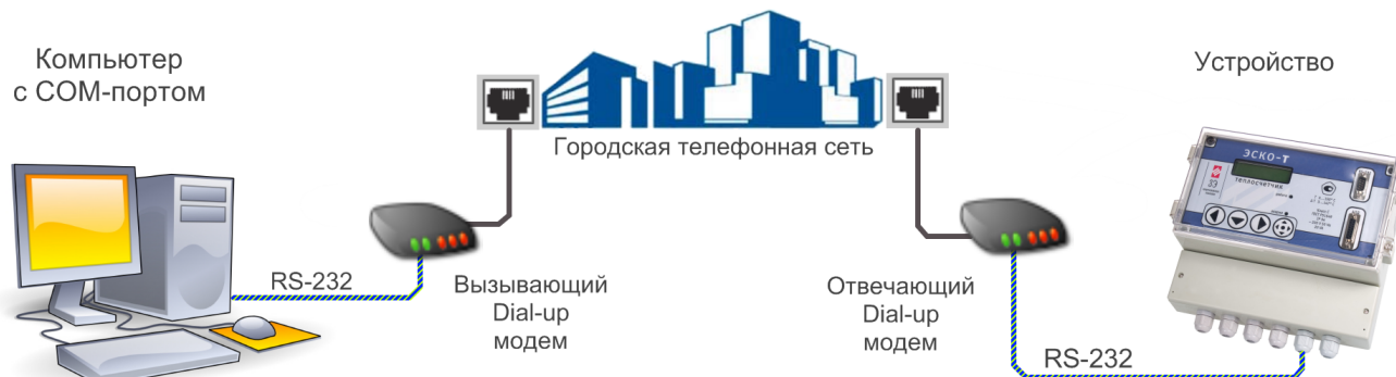
Рисунок 25. Общая схема организации подключения устройств через Dial-up модемы
