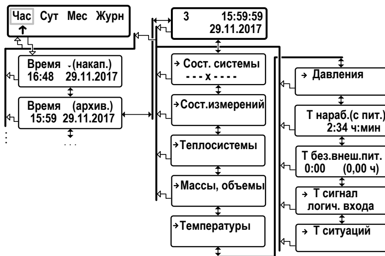
в) окна индикации данных архивной записи
